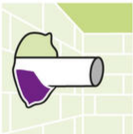
Voor het vullen van leidingdoorvoeren.
